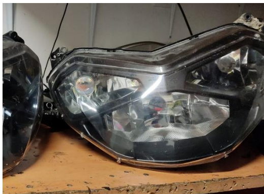
Slika 12: predelan žaromet motocikla Aprilia RST Futura - dodan 1,8" LED projektor v levem fokusu
