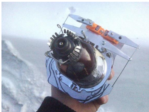
Slika 8: samogradnja prve verzije adaptivnega žarometa
