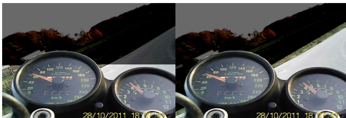
Slika 5: osvetljeni del cestišča pri klasičnem zasenčenem (levo) ter pri adaptivnem zasenčenem žarometu (desno)
