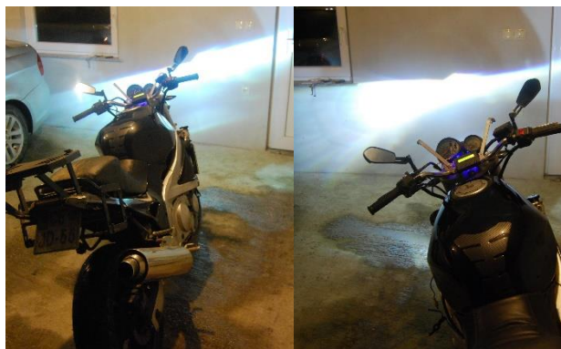
Slika 10: delovanje žarometa z izklopljeno (levo) in vklopljeno (desno) funkcijo prilagajanja svetlobnega snopa
